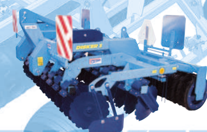
габариты машины в транспортном положении не превышают 3 м
